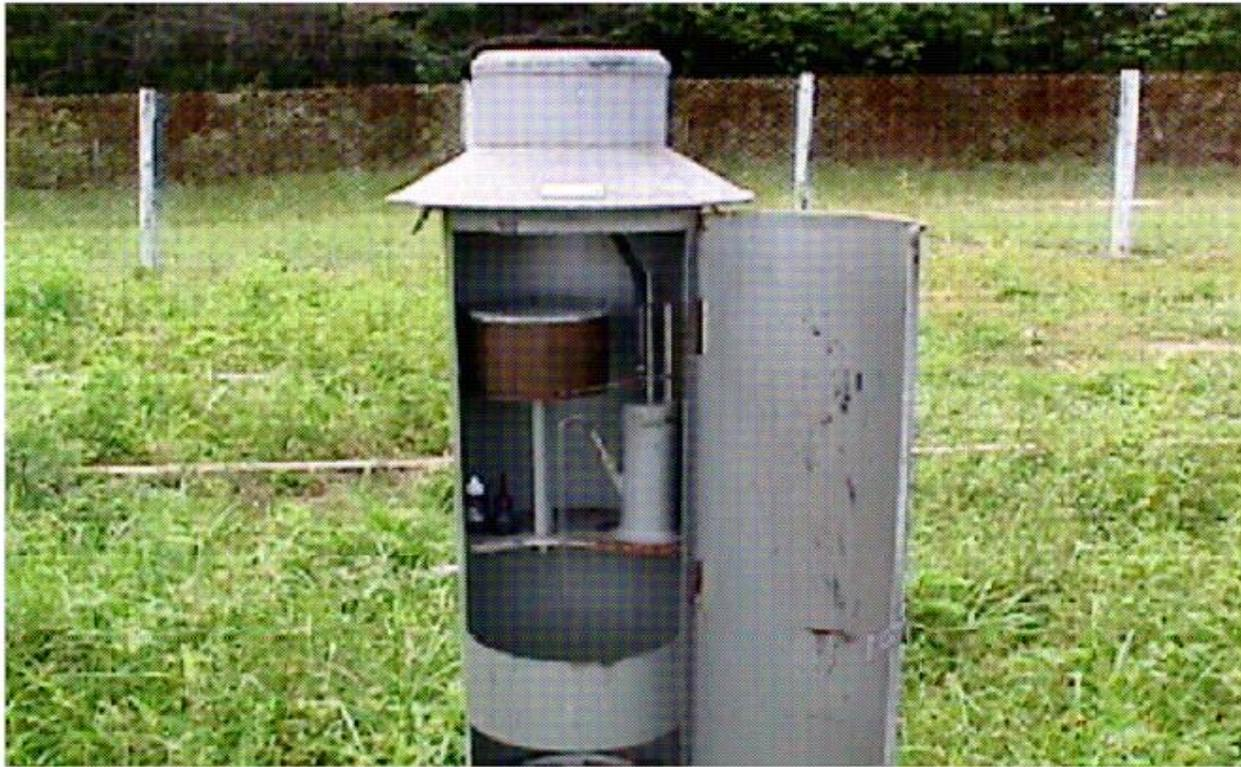
Registrador automático, trabalhando em associação a um mecanismo de relógio e que permite o registro de precipitações em intervalos inferiores a 24 horas
