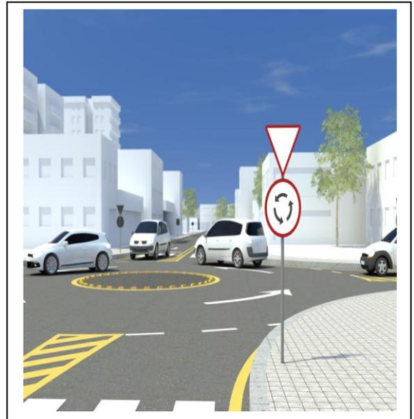
Figura 46: Vista das placas R2 e R33 (Dê a Preferência e Sentido Circular Obrigatório).
