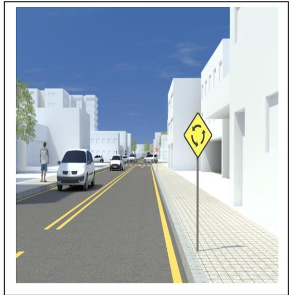
Figura 42: Vista da Placa A12 instalada a 40 metros antes do cruzamento.
