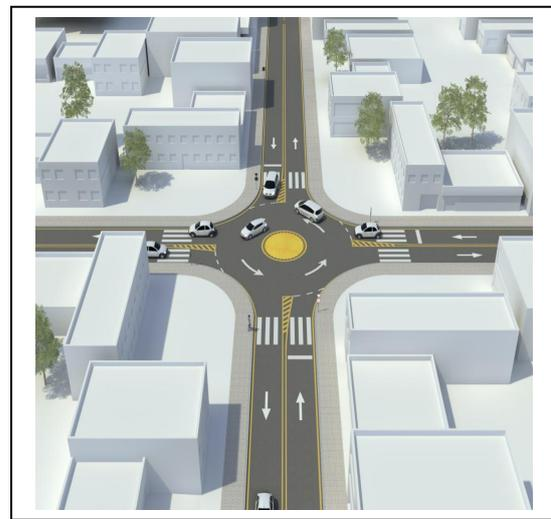
Figura 48: Vista da sinalização horizontal de uma mini-rotatória.
