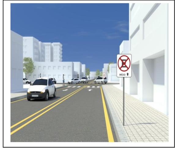
Figura 12: Vista da Placa R6 c1, instalada a 12 metros do cruzamento (Proibido estacionar e parar, Início).
