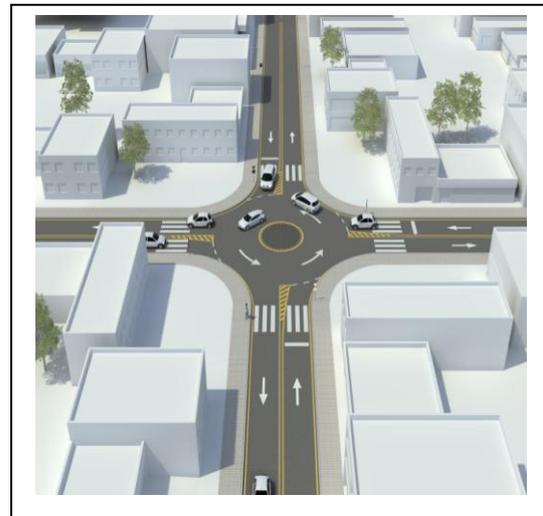
Figura 15: Sinalização horizontal de uma mini-rotatória.
