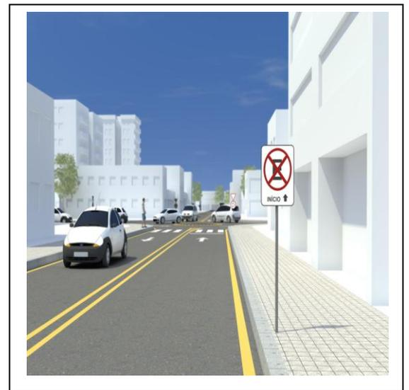
Figura 44: Vista da Placa R6 c1, instalada a 12 m do cruzamento (Proibido estacionar e parar, Início).
