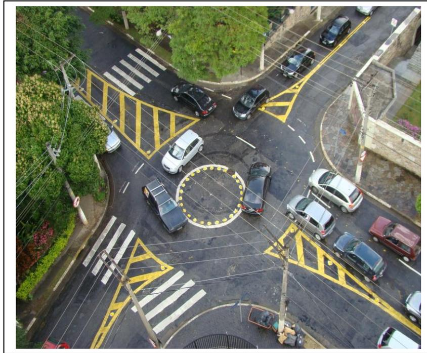
Figura 34: Mini-rotatória demarcada com sinalização horizontal.
